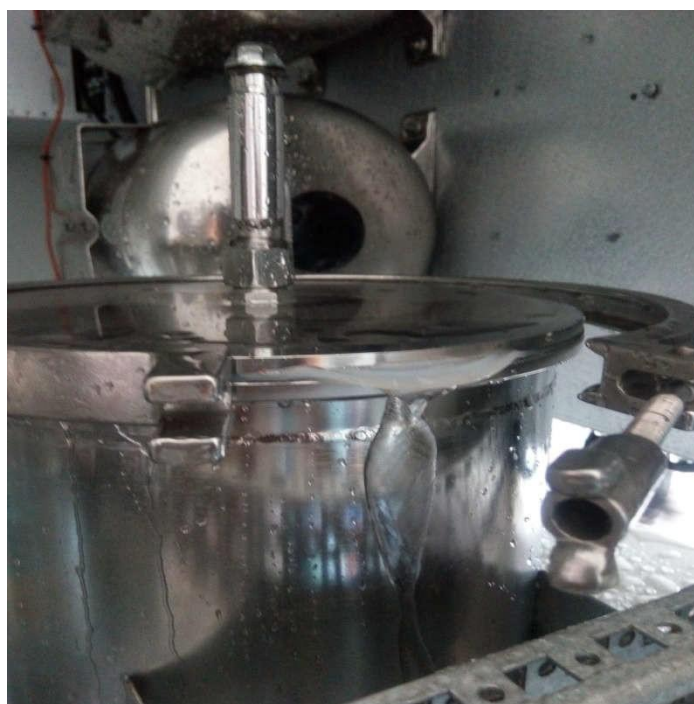
图 8.8 去离子罐上端封口位置示意图
